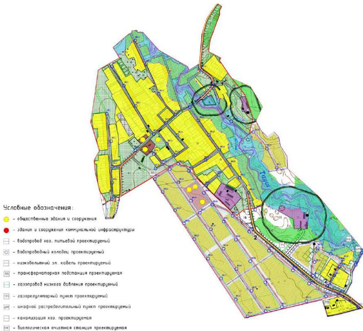
**Рисунок 3. Схема перспективных сетей коммунальной инфраструктуры с. Алаторка.**
