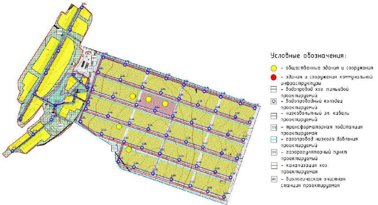
**Рисунок 9. Схема перспективных сетей коммунальной инфраструктуры д. Баранцево.**
