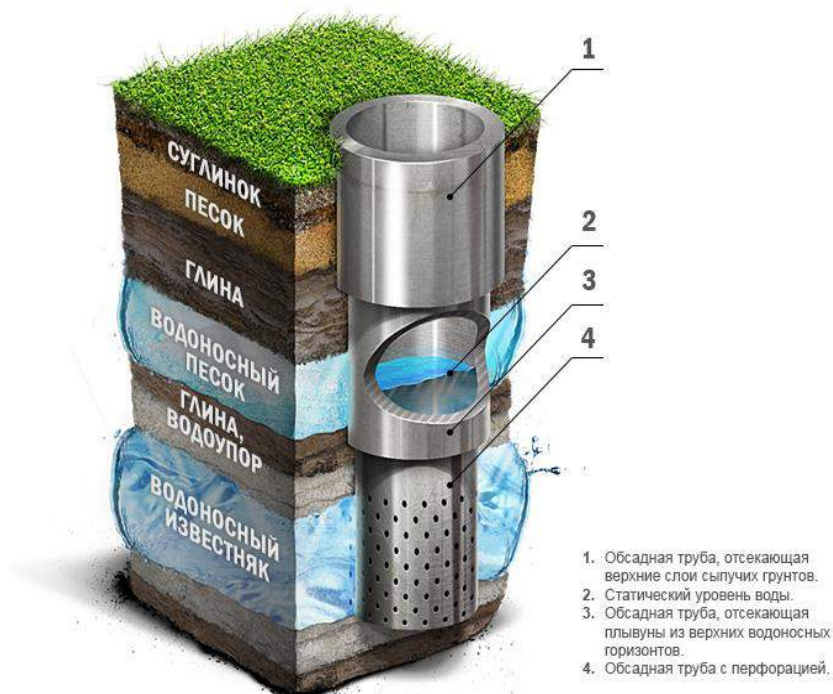
Рисунок 6. Схема артезианской скважины.
