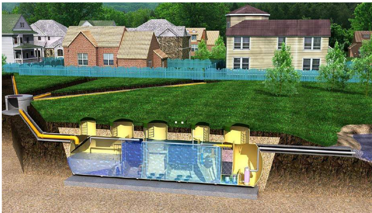
Рисунок 8. Схема биологической очистной станции.
